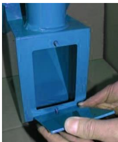
Fot.1. Pokrywa otworu rewizyjnego
