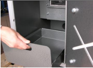
Fot.1. Usuwanie popiołu za pomocą szuflady popielnika.
