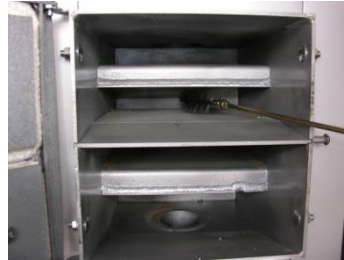
Fot.5. Powierzchnie wymiennika czyścić szczotką lub odkurzaczem.
