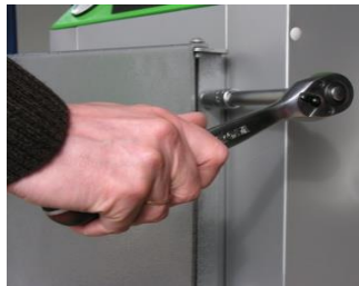
Fot.7. Regulacja drzwiczek (poluzować śruby, ustawić drzwiczki, dokręcić śruby).
