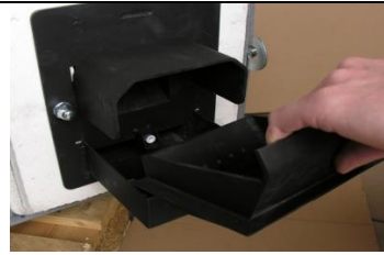
Fot.3. Czyszczenie tygla palnika QPell
